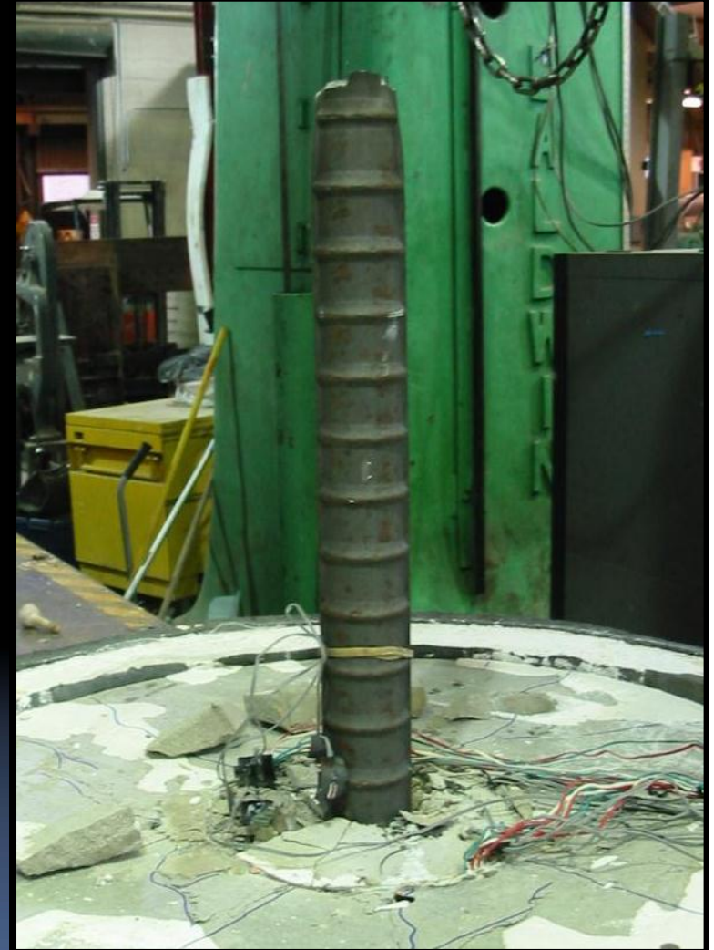
Long l_e : bar fracture
